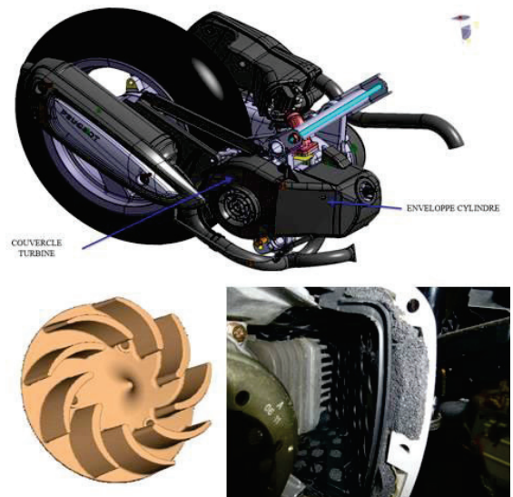
Figure 8: Exemple de prototypage sur ensemble GMP. Modification de la turbine de refroidissement ou de l'enveloppe cylindre
