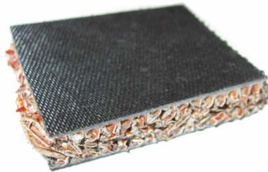
Figure 2 : Ecrasement d'une éprouvette ECA-R pour le chargement ( E_T ) ECA-R failure shapes for loadings ( E_T )
