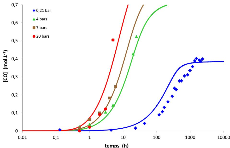
**Fig. 3.** Courbes d'accumulation des groupes carbonyles dans les films de matrice TACTIX entre 0,21 et 20 bars d'oxygène à 150 °C. Comparaison des simulations (traits continus) aux données expérimentales (points).
