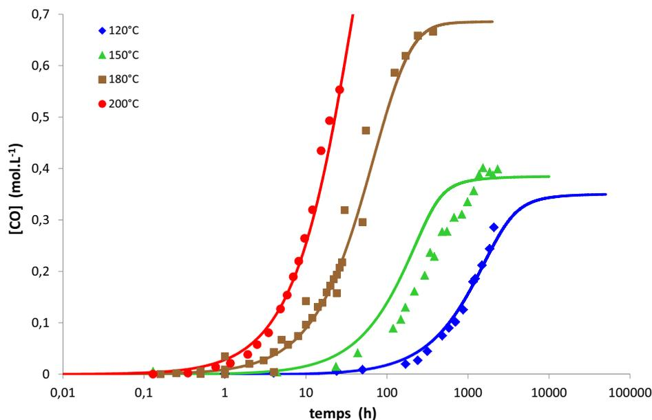
**Fig. 4.** Courbes d'accumulation des groupes carbonyles dans les films de matrice TACTIX sous 0,21 bar d'oxygène (air) entre 120 et 200 °C. Comparaison des simulations (traits continus) aux données expérimentales (points).
