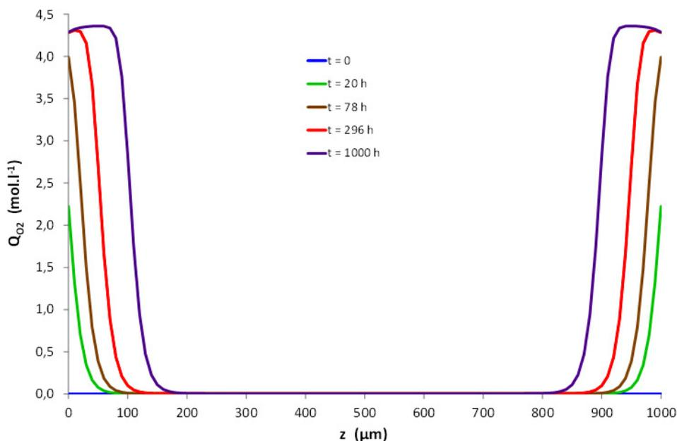
**Fig. 7.** Profils d'oxydation dans l'épaisseur d'une plaque de matrice TACTIX après 20, 78, 296 et 1000 h d'exposition sous 0,21 bar d'oxygène (air) à 200 °C.
