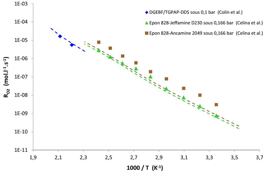
**Fig. 5.** Graphe d'Arrhenius entre et 25 et 200 °C de la vitesse maximale d'oxydation de films de matrices EPO-DA de 100 µm d'épaisseur. Comparaison des simulations (traits continus) aux données expérimentales (points).
