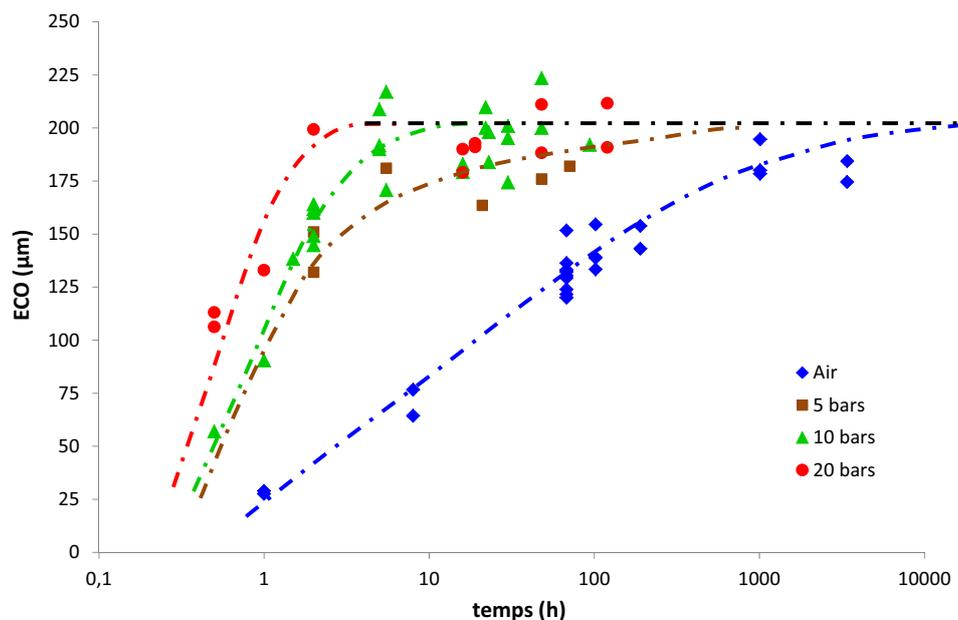
**Fig. 6.** Courbes cinétiques de l'épaisseur de couche oxydée de la matrice TACTIX entre 0,21 et 20 bars d'oxygène à 200 °C. Valeurs déterminées par microscopie optique sur des sections droites préalablement polies.
