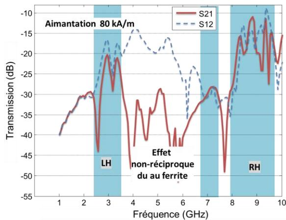
**Figure 6. Mesure de la ligne sous champ magnétique.**
