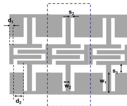
Figure 1. Schématisation de la structure. La cellule unitaire est repérée par le cadre pointillé.  $W1=1.4\text{mm}$ ,  $W2=0.1\text{mm}$ ,  $S1=0.4\text{mm}$ ,  $S2=0.65\text{mm}$ ,  $d1=0.2\text{mm}$ ,  $d2=0.65\text{mm}$
