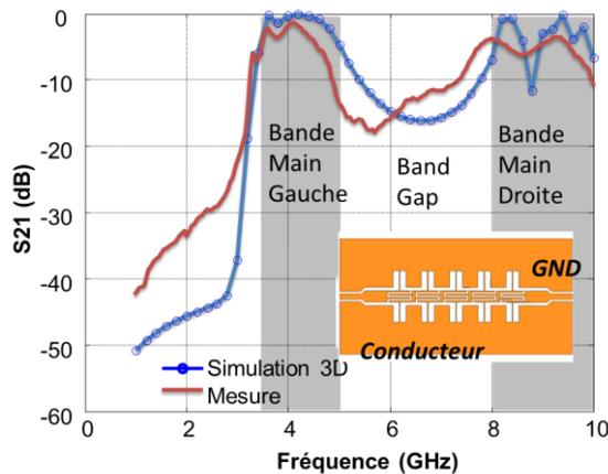
Figure 3. Mesure de la ligne sur substrat alumine.
