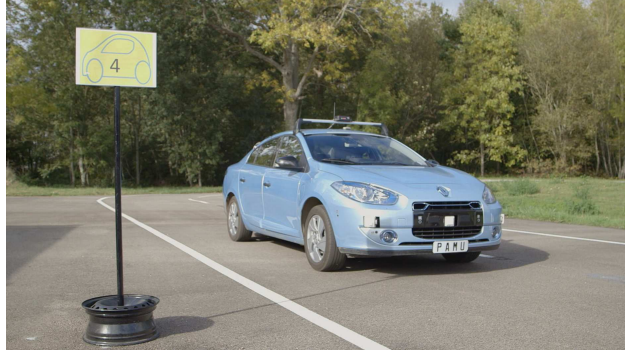
Figure 1: Driverless valet parking vehicle used in the PAMU (Plateforme avancée de Mobilité Urbaine) project (Laboratoire Heudiasyc, 2015).
