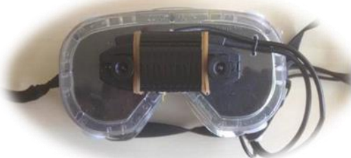
Figure 5: caméras et afficheurs Vuzix montés sur un masque de protection
