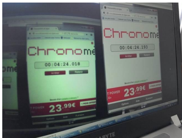
Figure 19: retard total mesuré par copie d'écran d'une horloge
