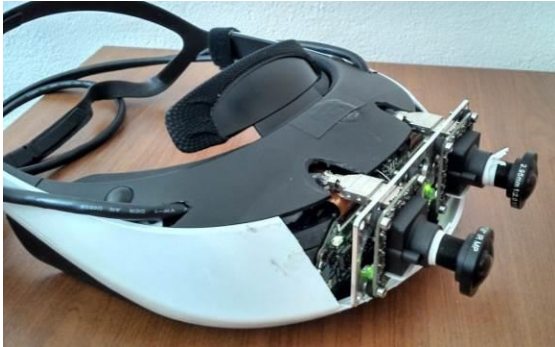
Figure 10: Caméras montées sur le casque Sony
