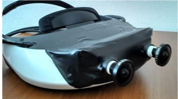
Figure 11: caméras montées, avec une protection plastique
