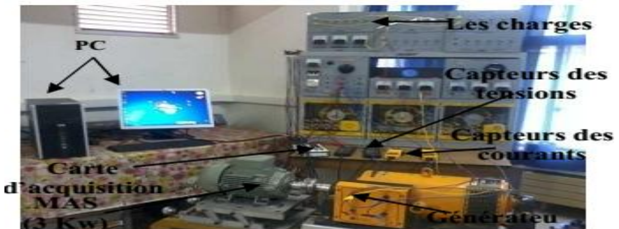
Figure 5 : Banc d'essai destiné au diagnostic du défaut de barres
