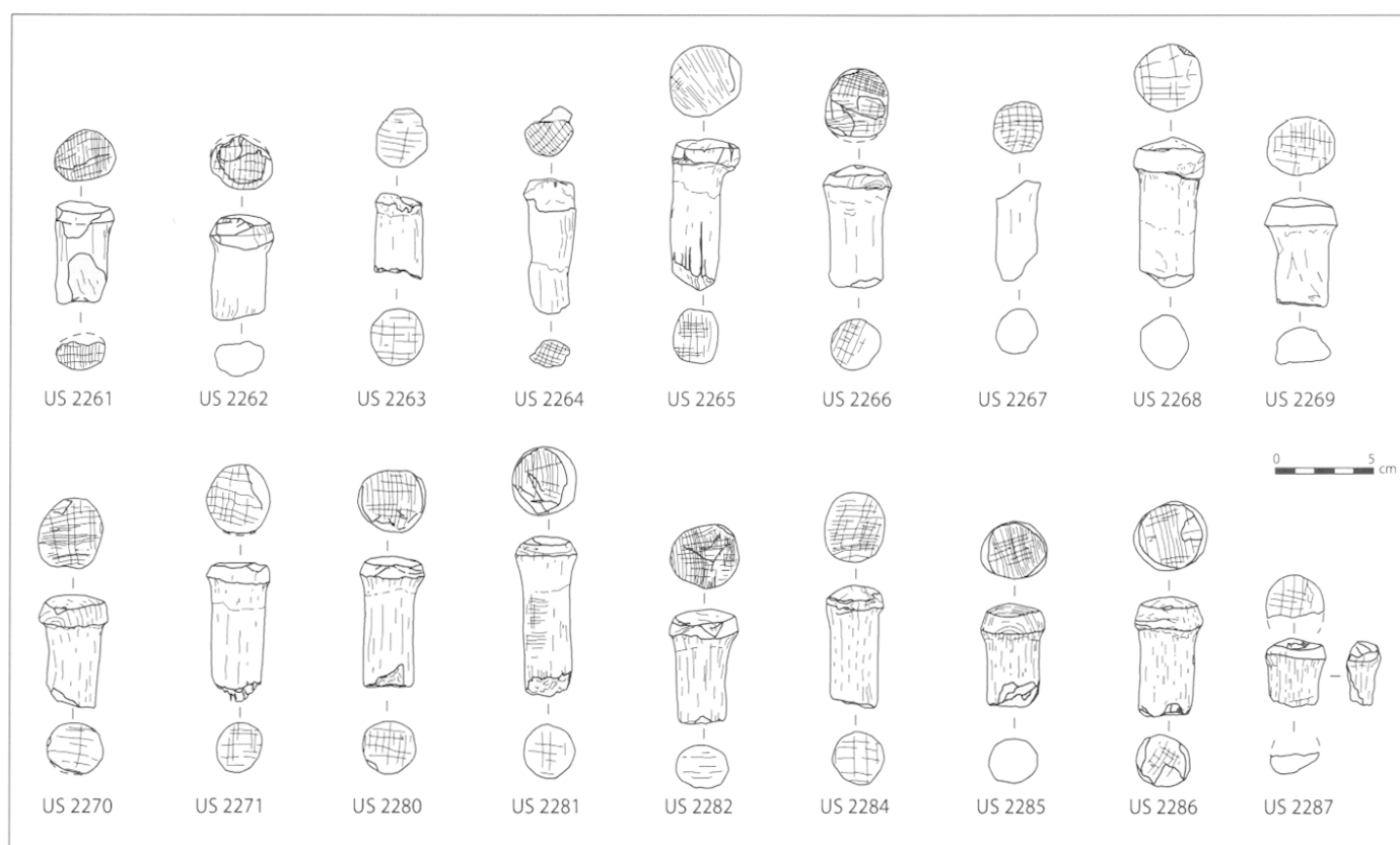
Fig. 20: Extrémités de gournables extraites du bordé 2183.
