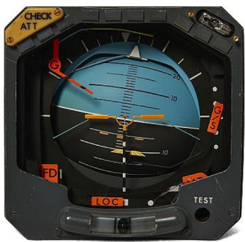
Figure 2: indicateur d'attitude horizon-mobile
