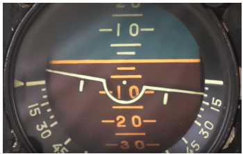
Figure 4 : indicateur d'attitude maquette-avion mobile
