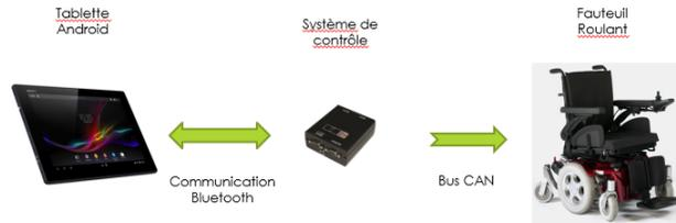
**Figure 2:** Contrôle du mouvement du fauteuil.
