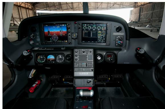
**Figure 1. Cockpit numérique ("Glass cockpit") du Cirrus® SR20 utilisé en formation initiale de pilotes de combat**
