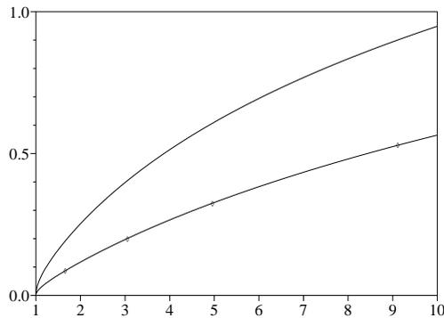
FIGURE 2 – La vitesse sans dimension  $\sqrt{X^*} = v^*/\sqrt{b_2 d}$  en fonction de  $\alpha_2/\alpha_1$  pour différentes valeurs de  $y = b_2/b'_2$ , à savoir  $y = 0,04$  (en bas) et  $y = 0,1$  (en haut). Les points correspondent à des simulations numériques du système non linéaire d'équations aux dérivées partielles.
