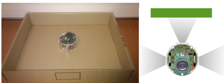
Figure 4 : Gauche : dispositif expérimental, le robot e-puck (Mondada et al., 2009) dans son environnement. Droite : robot e-puck face à un mur (vert) et cônes de détection de murs à gauche, devant, et à droite (zones grises dégradées).
