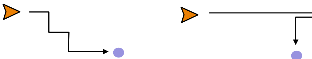
Figure 7 : Exemples de comportements appris par l'agent au cours de différentes exécutions de l'expérimentation. Gauche : comportement consistant à avancer en escalier jusqu'à s'aligner avec la cible. Droite : comportement consistant à avancer en ligne droite jusqu'à ce que la cible sorte du champ sensoriel, puis revenir en arrière d'une cellule pour s'aligner sur la cible. L'agent ne perçoit pas la distance de la cible, il apprend à la localiser par le fait qu'elle sorte de son champ sensoriel.
