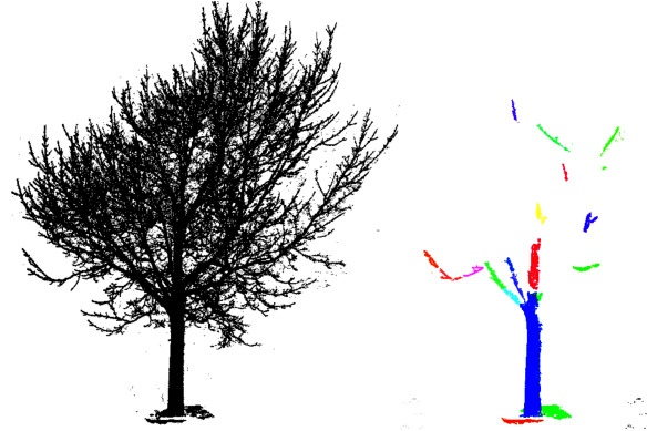
Figure 6: Résultat de la segmentation d'un arbre isolé (après filtrage des segments non pertinents). Gauche : nuage de points initial. Droite : résultat filtré de la segmentation.
