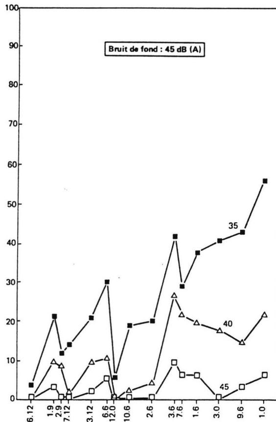
Figure 23b Variation du nombre de mots compris pour les différentes formes de courbes isolement-fréquence et pour trois valeurs de l'isolement global — 35, 40, 45 dB(A)
