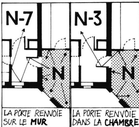
A noter enfin que dans ce dispositif spatial, le sens d'ouverture de la porte d'accès au dégagement favorise l'isolement porte ouverte. Si cette porte ouvrait dans l'autre sens, l'isolement ne serait que de 3 à 4 dB(A) au lieu des 7 à 8 dB(A) annoncés ici (la porte fait chicane et renvoie le son provenant de l'espace de distribution sur une surface semi-absorbante disposée face à la porte d'accès à la chambre).
