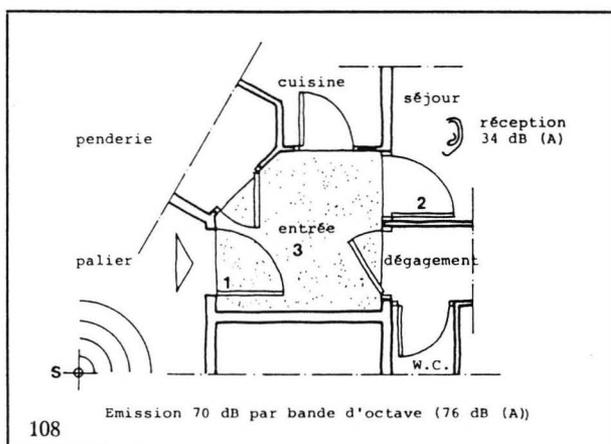
Figure 107 : Affaiblissements acoustiques des types usuels de portes.
