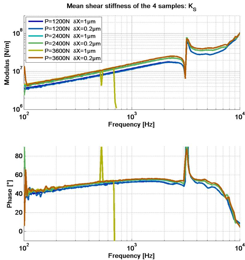
FIGURE 5 – Raideur moyenne de cisaillement dynamique des shims.
