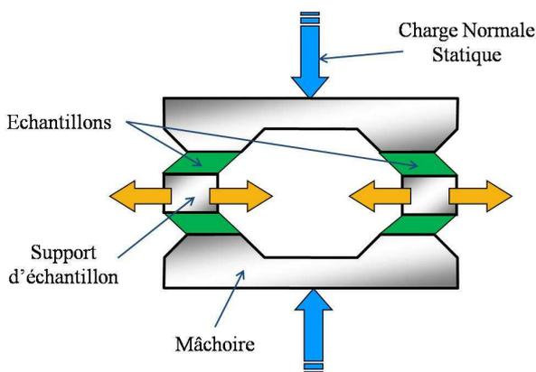
FIGURE 1 – Schéma de principe du viscoanalyseur
