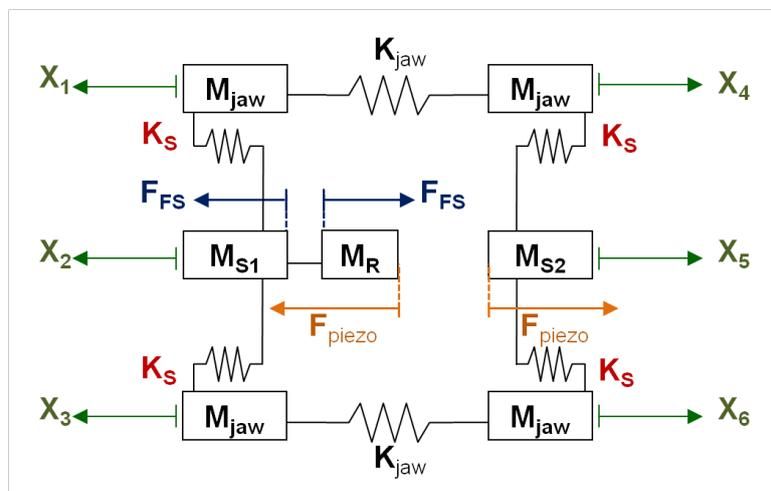
FIGURE 3 – Modélisation rhéologique du viscoanalyseur en cisaillement dynamique.
