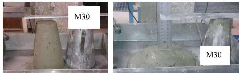
Figure 3. Affaissement au cône MBE. Affaissement à (t = 0) Affaissement à (t = 2 s)
