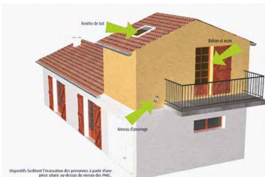
Figure 1. Exemple de la création d'un étage refuge (source : MEDDE & METL, 2012).
