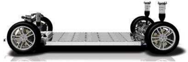
Fig.7 Pack batterie de véhicule TESLA intégré dans le plancher [5]
