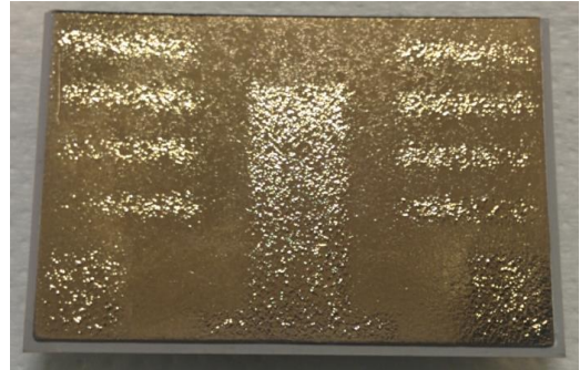
Fig.4 Empreinte des motifs de la métallisation supérieure du substrat sur la métallisation inférieure.
