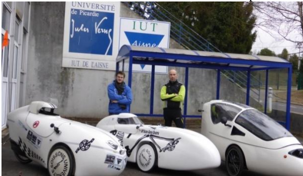
fig 1: Différentes réalisations de cycles électriques motorisés entièrement carénés (de 50 kg à 85 kg) [8, 9, 10].
