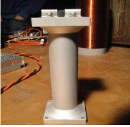
Fig.4 dispositif d'estimation des pertes par calorimétrie
