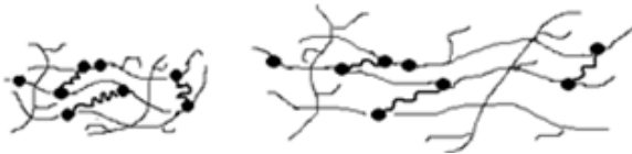
Fig.10 Schéma d'orientation des chaînes moléculaires sous l'effet de la précontrainte
