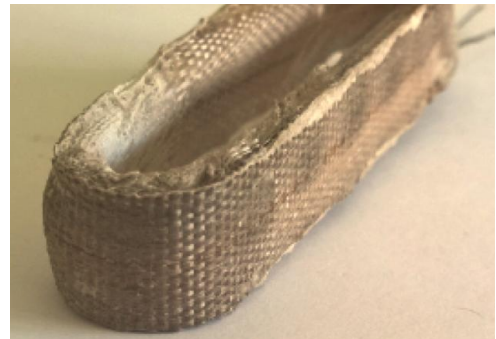
Fig.16. Photographie d'une bobine inorganique qui a subi des tests à 500°C.
