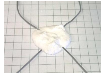
Fig.14. Echantillon permettant de tester l'influence du ciment d'enrobage que les propriétés de l'isolation inter-spices.
