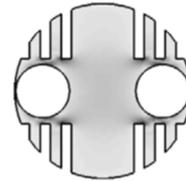
Figure 1: SR à rotor massif à trous
