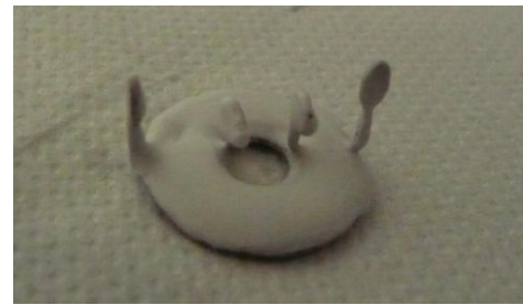
Figure 5 : Spirales et rondelle enroulées et recouvertes d'une peinture céramique.
