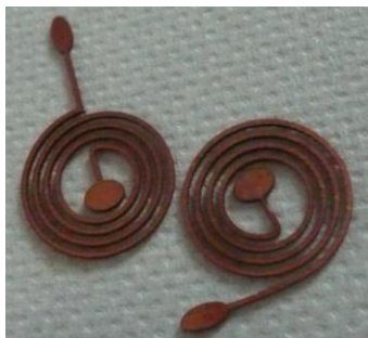
Figure 4 : Spirales usinées par électro-érosion.
