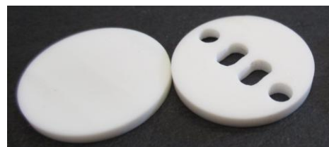
Figure 11 : Rondelles en alumine. Diamètre 20 mm.
