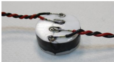
Figure 13 : Coupleur (TIC). Diamètre 20 mm.
