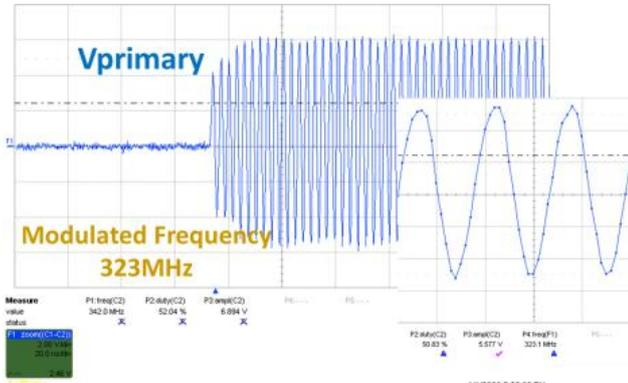
Fig. 3. Tension primaire du transformateur sans noyau
