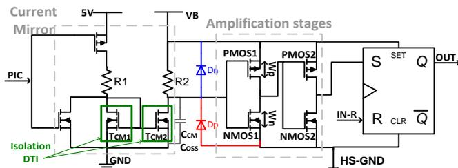
Fig. 10. Topologie de « level-shifter » haute tension
