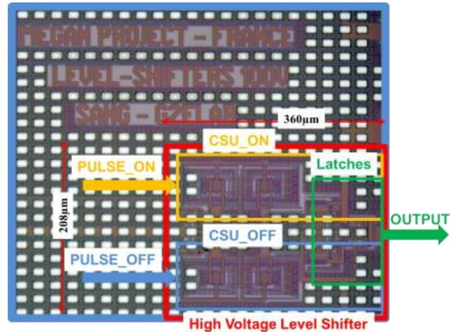
Fig. 11. Photo microscopede « level-shifter » pulsé à 100V
