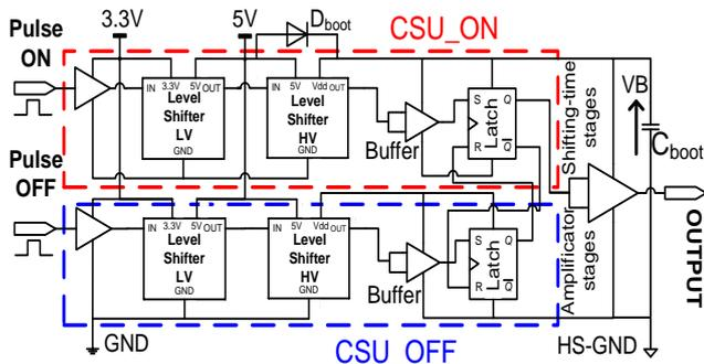
Fig. 9. Schéma du « level-shifter » haute tension avec CSUs
