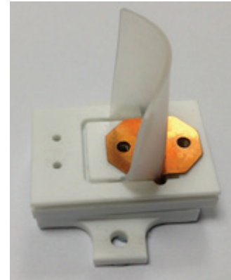
Figure 3 : Boîtier spécifique pour composant Haute Tension discret (DISCO)
