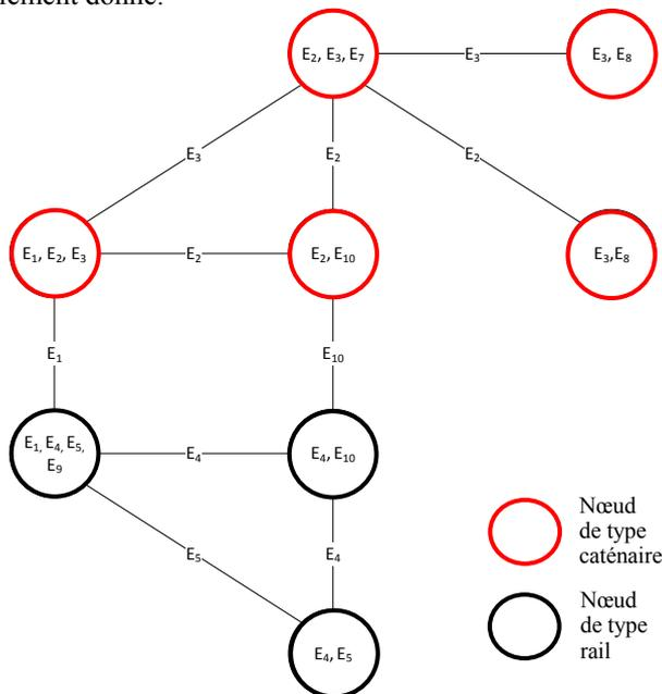
Fig. 6 : Exemple de graphe d'interactions électriques entre éléments
