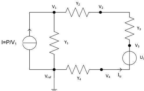
Fig. 5: Analyse nodale modifiée : exemple d'application
