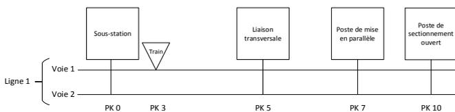
Fig. 2 : Schématisation d'une ligne ferroviaire à deux voies
