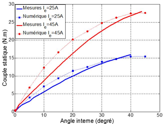
Fig. 10 : Couple statique de l'accouplement magnétique.
