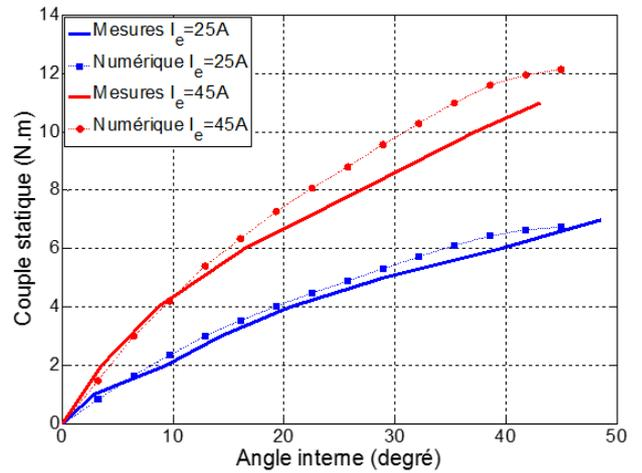
Fig. 11 : Couple statique du moteur à inducteur supraconducteur.
