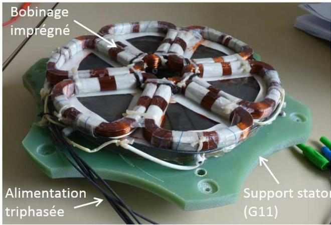
Fig.6 : Culasse statorique et bobinage statorique.
