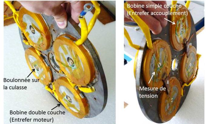
Fig.4 : Bobines supraconductrices montées sur la culasse ferromagnétique.
