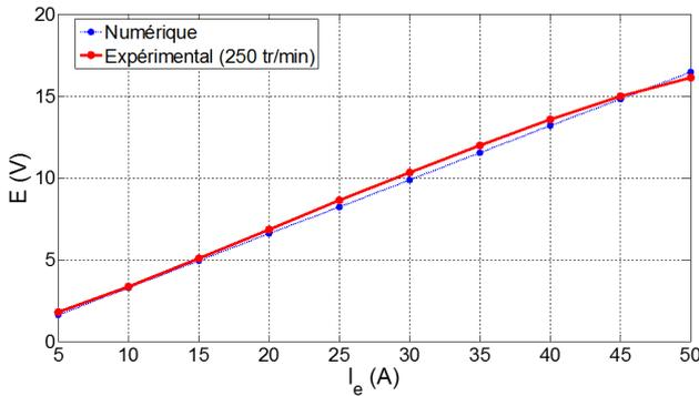
Fig.14 :Caractéristique à vide  $E(I_e)$  en fonctionnement génératrice.
