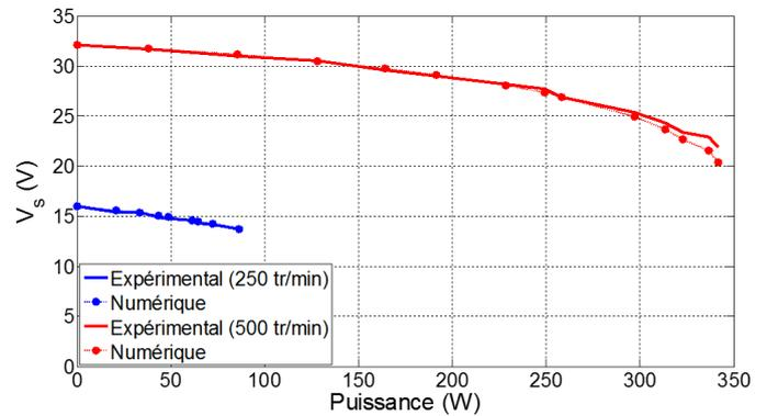
Fig.16 : Caractéristique  $V_s(P)$  de la génératrice en charge.
