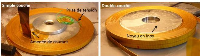
Fig.3 : Bobines supraconductrices de l'accouplement et de l'inducteur.
