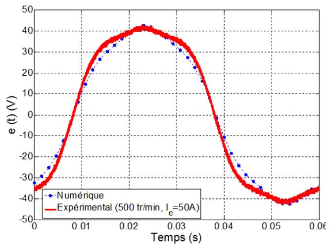
Fig. 12 : Force électromotrice induite par phase.
