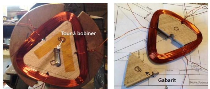
Fig. 5 : Bobine de l'induit en cuivre.
