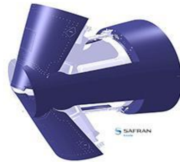
Fig.1 Phase Deploy d'un inverseur de poussée
