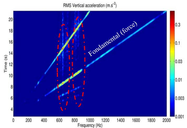
Figure 14: Spectrogramme de l'accélération verticale de la colonne
