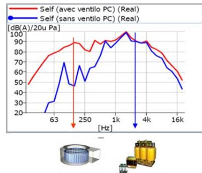
Figure 1: Bruit des selfs dans un convertisseur
