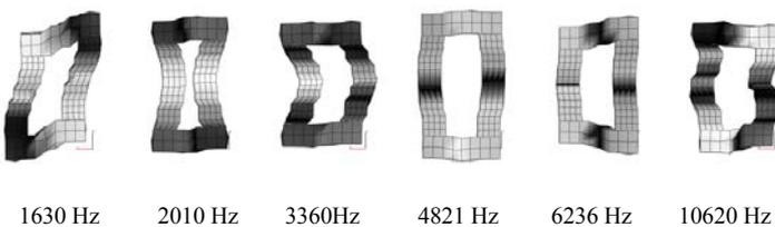
Figure 7: Analyse modale expérimentale obtenue sous Pulse
