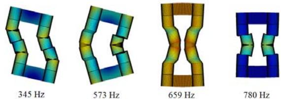
Figure 10: Analyse modale structure 1 par E.F.
