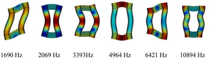
Figure 8: Analyse modale obtenue par la MEF
