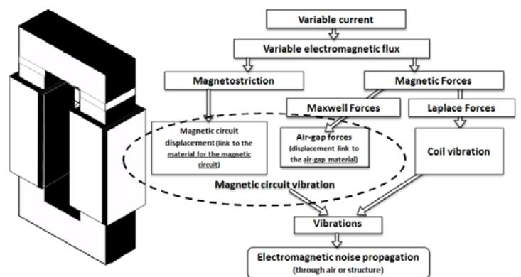
Figure 2: Origine du bruit et des vibrations d'origine magnétique
