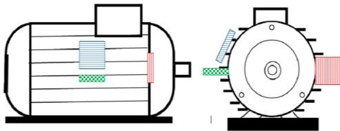
Fig.1 Différentes positions du capteur
