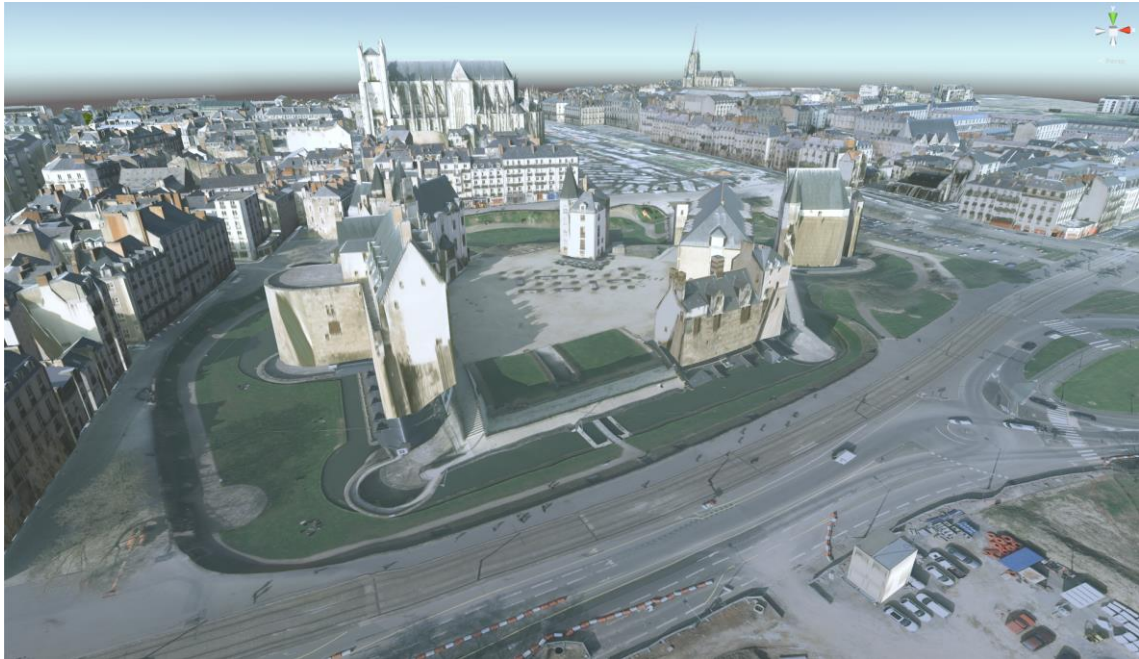
Figure 33 : Absence de géométries (murs d'enceinte du château des Ducs de Bretagne).
