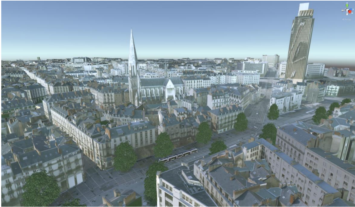
Figure 37 : Incrustation d'objets 3D (arbres et tramway) dans le socle LoD3 du secteur PSMV
