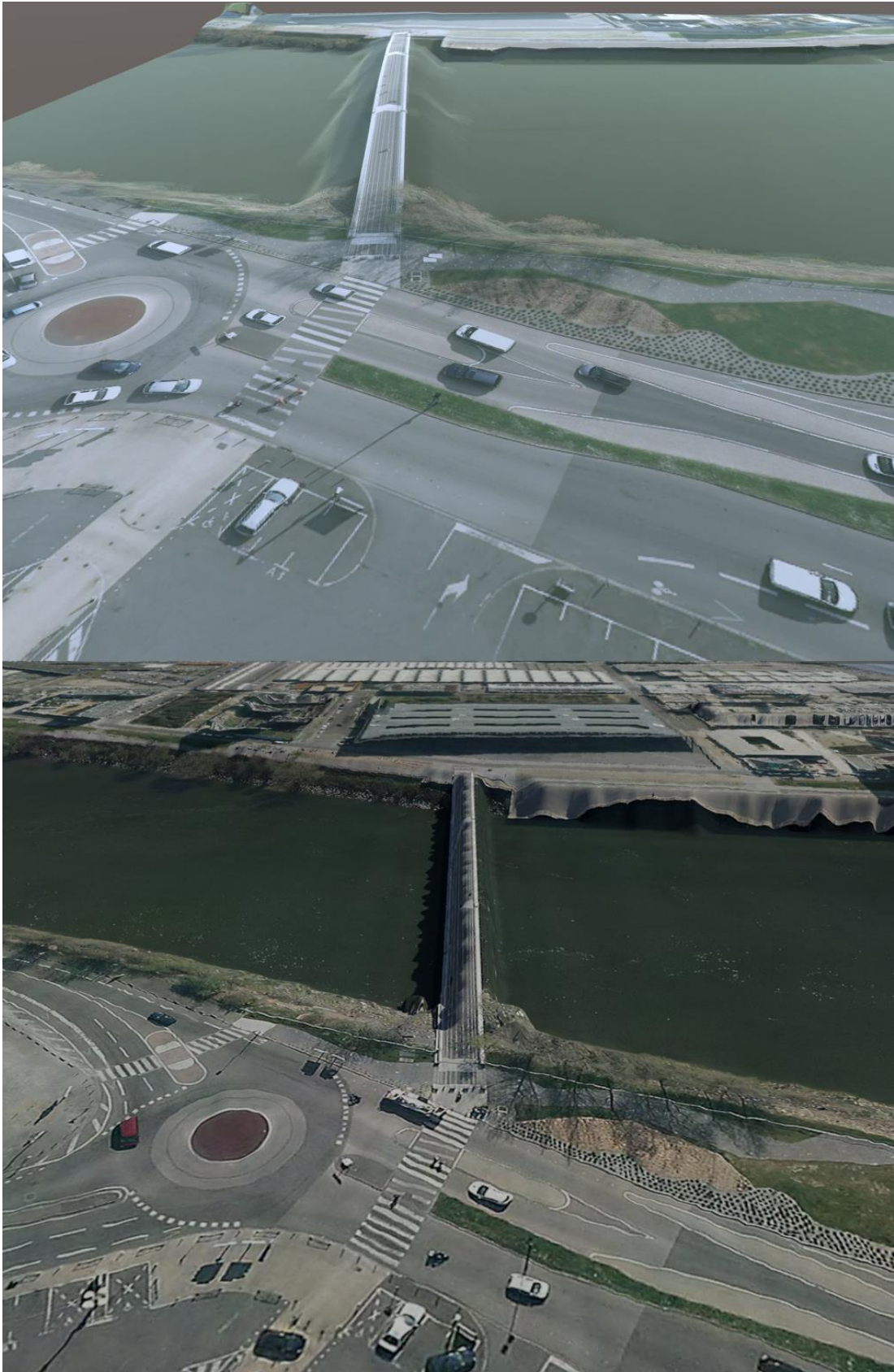
Figure 16 : Comparaison du rendu de la Passerelle Victor Schœlcher avec le maillage et les textures encapsulés dans la maquette LoD 2 (en haut) avec le rendu du même endroit couplant une autre technique de simplification du Modèle Numérique de Terrain avec les orthophotographies à fine résolution. Si le problème de débord est très clairement résorbé, on constate par contre l'apparition d'un rendu problématique en bord de Loire (« effet de nappe » au pied du tribunal).
