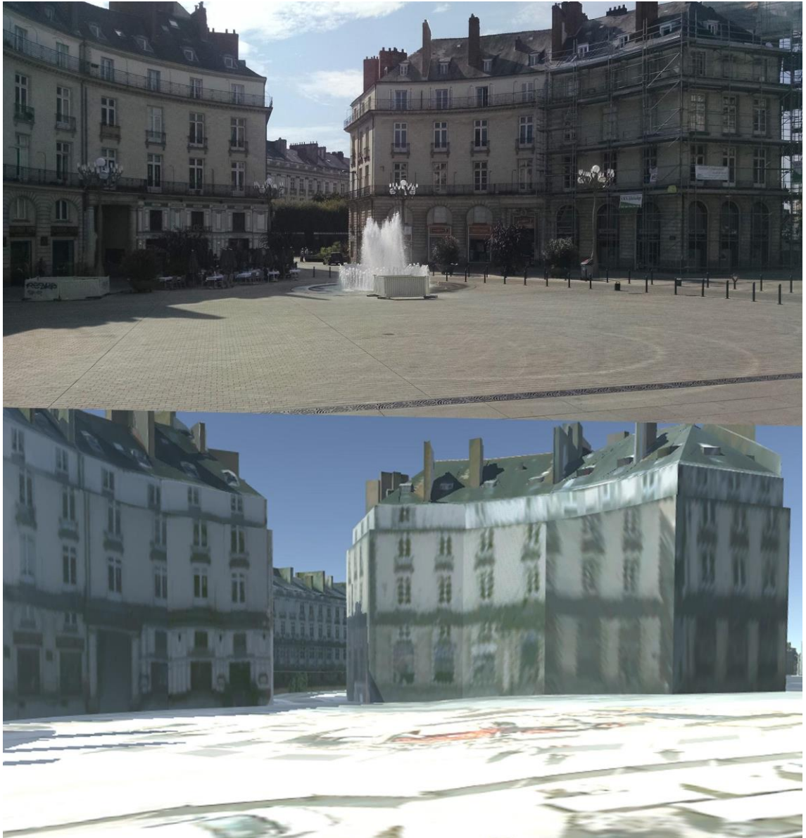
Figure 23 : Comparaison d'une photo de la place Graslin et du rendu de la maquette CityGML LoD 3 texturée (secteur PSMV) obtenue dans l'outil logiciel Unity. Les points de vue et conditions de prises de vue sont approximativement identiques entre le modèle numérique et la photo.
