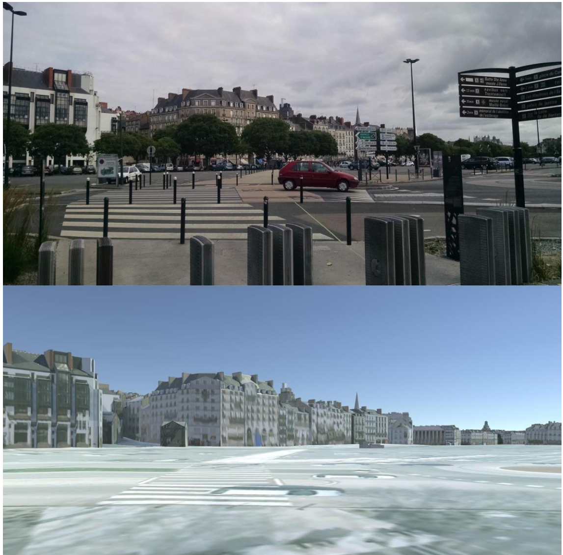
Figure 24 : Comparaison d'une photo de l'Ile Gloriette et du rendu de la maquette CityGML LoD 3 texturée (secteur PSMV) obtenue dans l'outil logiciel Unity. Les points de vue et conditions de prises de vue sont approximativement identiques entre le modèle numérique et la photo.
