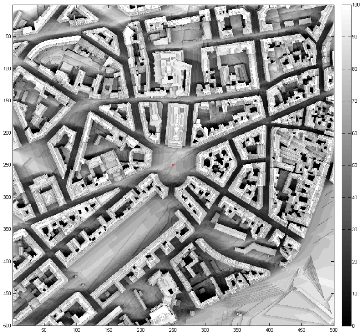
Figure 26 : Analyse et représentation des ombres portées le 10 juillet 2015 à l'aide du logiciel Solweig. Le Modèle Numérique de Surface utilisé est issu de la transformation des modèles de terrain et maquettes de bâtiments encapsulés dans le fichier OBJ du socle 3D de la zone d'étude.
