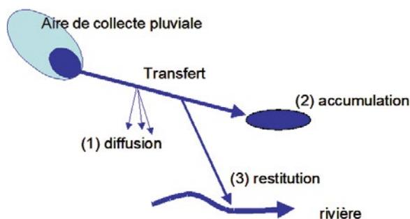
Figure 3 : Les étapes hydrologiques pouvant conduire à l'inondation par Ruissellement Intense Pluvial (RIP).
