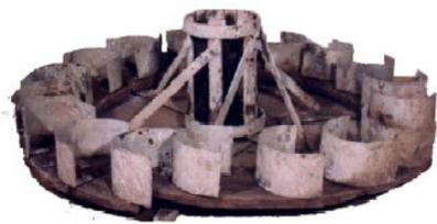
Fig. 5 : roue à augets tournant avec le poids de l'eau (II<sup>ème</sup> s. av. JC) (Source : [www.musee-hydrelec.fr](http://www.musee-hydrelec.fr))
