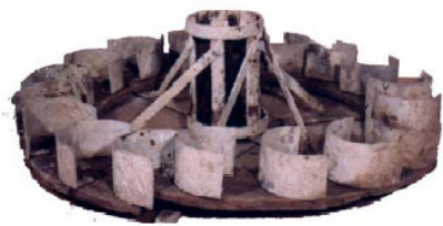
Fig. 5 : roue à augets tournant avec le poids de l'eau (II ème s. av. JC) (Source : www.musee-hydrelec.fr )
