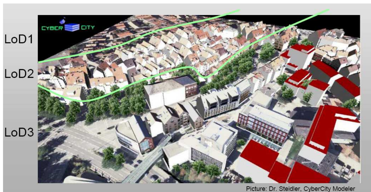
Figure 4. Intégration de différents niveaux de détails selon la distance. Source http://www.citygml.org/docs/Kolbe_CityGML_OGC_NYC_CAD+GIS_WG.pdf
