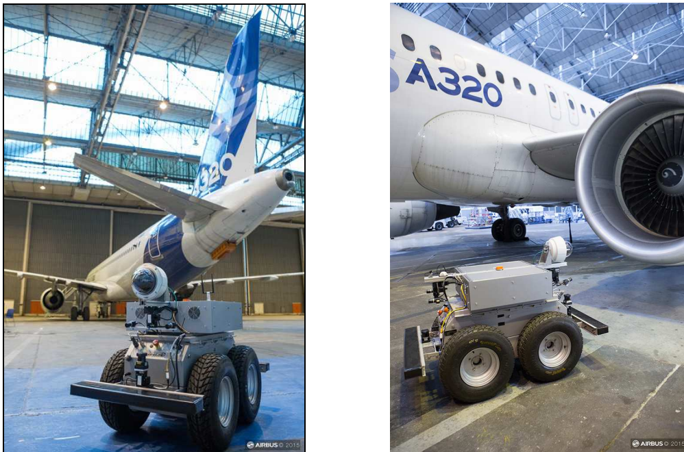
Figure 1 Le robot AIR-COBOT en cours d'inspection dans un hangar
