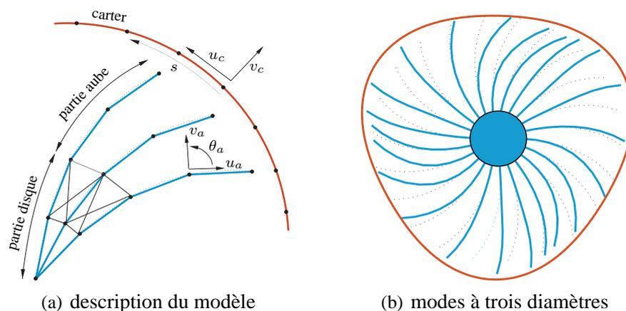
FIG. 2 – Caractéristiques de l'ensemble roue aubagée/carter
