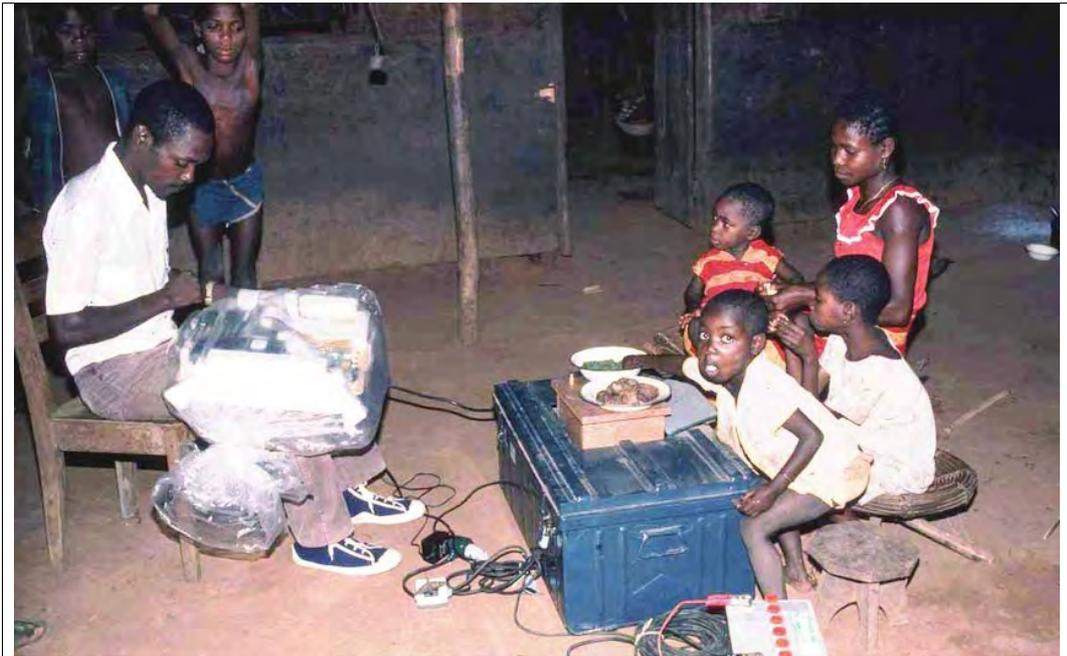
Mesure de la consommation individuelle dans un plat collectif. La balance électronique est protégée dans la caisse métallique et reliée au système informatique, protégé de la forte humidité ambiante par une enveloppe plastique. Les frappes au clavier de l'opérateur permettront d'identifier le consommateur et de mesurer le poids, au gramme près, de chacune des bouchées prélevées dans le plat commun.
