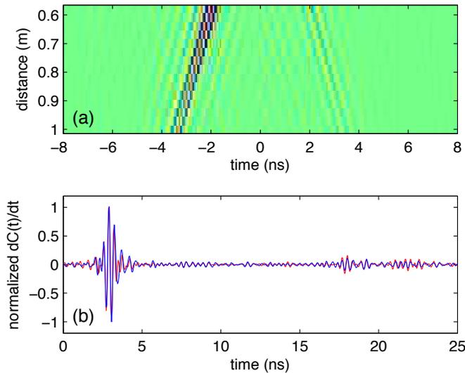
Fig. 3. (a) Représentation en couleur de  $C(t)$  lorsque la distance entre une antenne cornet et une sonde non-invasive augmente entre 0.55m et 1m. (b)  $dC(t)/dt$  (bleu) aux temps négatifs est comparé avec la réponse impulsionnelle mesurée activement (rouge).
