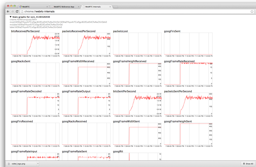
Outil intégré à Google Chrome pour mesurer les performances des applications WebRTC.
