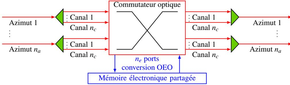
FIGURE 1 : Architecture générale du commutateur hybride considéré.
