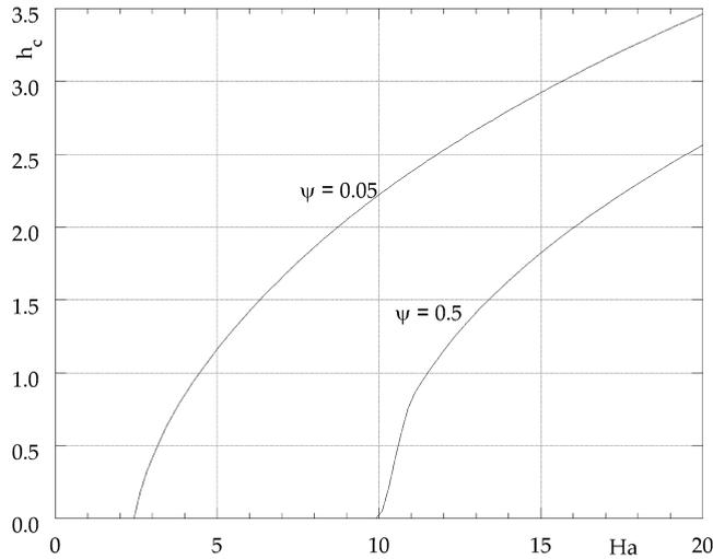
**Fig. 6.** Variation of  $h_c$  en fonction de  $Ha$  pour  $\psi = 0.05$ ,  $\psi = 0.5$  et  $Le = 0.01$ .
