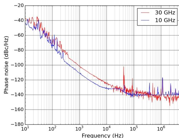
Figure 2 : Bruit de phase mesuré des deux COEO
