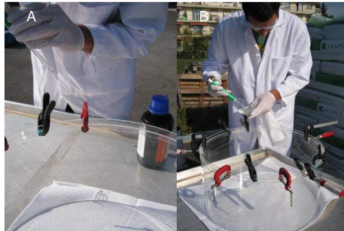
Figure 3. Cerclage soudé au chloroforme. (Photo : LEPSE)
