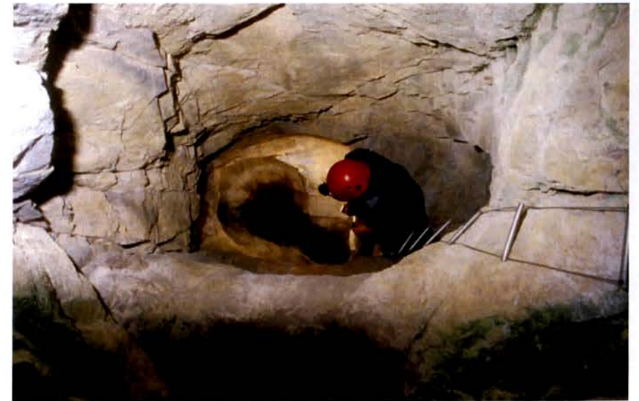
Figure 2 : Puits de mine entièrement travaillé par le feu et percé depuis la surface (secteur de la Pinée, mine du Fournel, L'Argentière-La Bessée).
